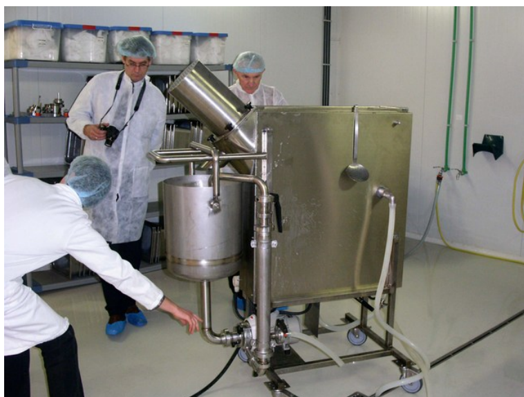
Foto 3. Sojamelkmachine voor het maken van een sojadrink.
