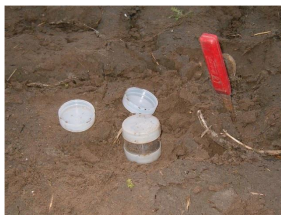
Foto 3d. Beide kanten van de ring worden afgesloten met een dop. Het monster kan worden vervoerd voor analyse.
