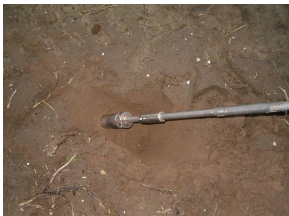
Foto 3a. Op ca. 15 cm diepte wordt een monsterring in de grond gebracht. De boor zorgt ervoor dat de ring in de grond snijdt zodanig dat de grond in de ring zo min mogelijk wordt samengedrukt.
