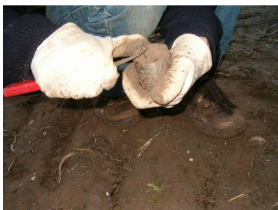
Foto 3c. De grond buiten de ring wordt voorzichtig afgesneden.
