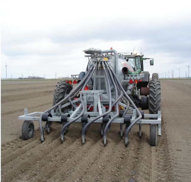
Figuur 2. Toediening van de varkensdrijfmest vóór poten met een bouwlandinjecteur
