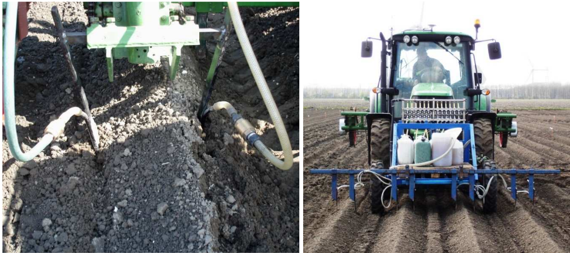
Figuur 3. Rijenbemesting met vloeibare N-meststoffen na poten
