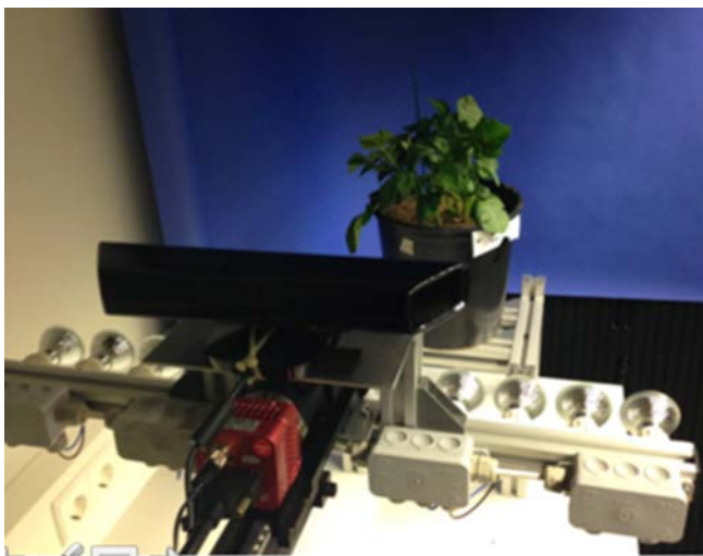
Figuur 8. Proefopstelling met de 3D camera en de aardappelplanten.
