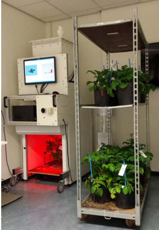
Figuur 6. De opstelling van de CropReporter die gebruikt is voor het opnemen van de fluorescentie beelden.
