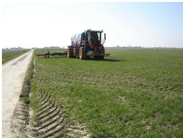
Zelfrijdende mestwagen Vredo VT3936, inhoud 17 m 3 , werkbreedte 12 meter
