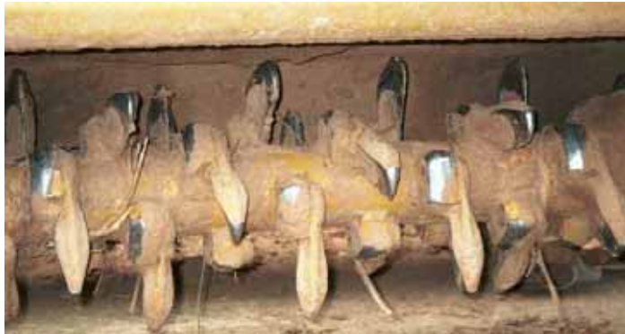
Foto 5. Dutzi-pennenfrees (detail). De tandenrotor voor het maken van een verkruid bed.
