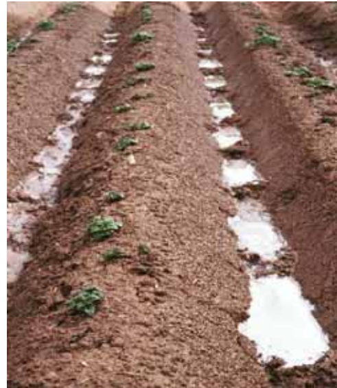
Foto 12. Water in de geul, 23-05-02, object aangeard, grote drempels: de rechter drempels zijn nog in takt, de linker zijn deels weggespoeld.
