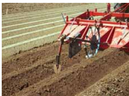
Foto 4. Prototype machine om drempels te vormen achter Steketee aanaarder met ruggvormkappen.
