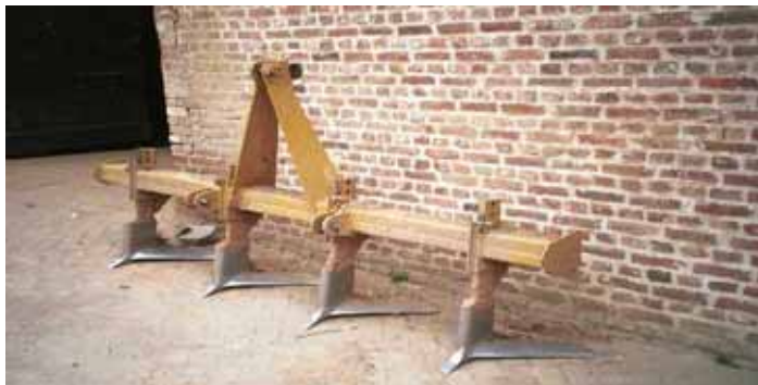
Foto 6. Dutzi-woelscharen (detail). Al naar gelang de instelling wordt de grond op 25 cm diepte iets opgelicht. De woelscharen en pennenfrees zijn ook gecombineerd gebruikt
