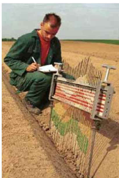
Foto 1. De reliëfmeter waarmee de vorm van de ruggen en drempels in 2001 en 2002 is gemeten.
