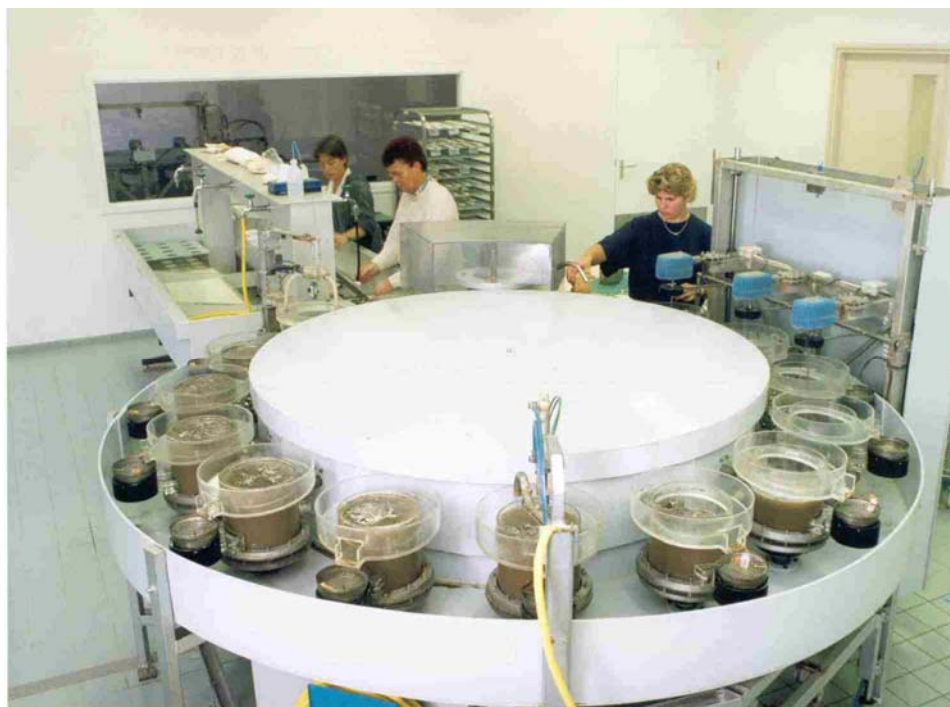
Figuur 1. Opspoelapparaat (carousel) voor het cystenonderzoek. Foto: NAK AGRO BV.
