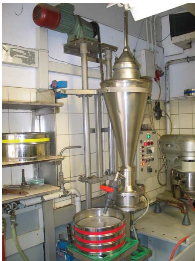
Figuur 2 Opspoelapparaat (Oostenbrinktrechter) voor vrijlevende aaltjes. Foto: Blgg bv
