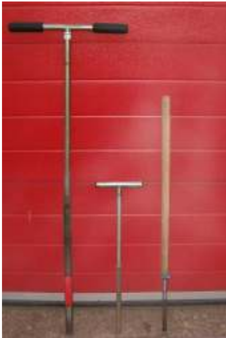
Figuur 2. type grondboren: Links: gutsboor 50 cm \Phi 3,5 cm Midden: gutsboor 25 cm \Phi 13 mm Rechts: AM-vrij gutsboor 5 cm \Phi 13 mm
