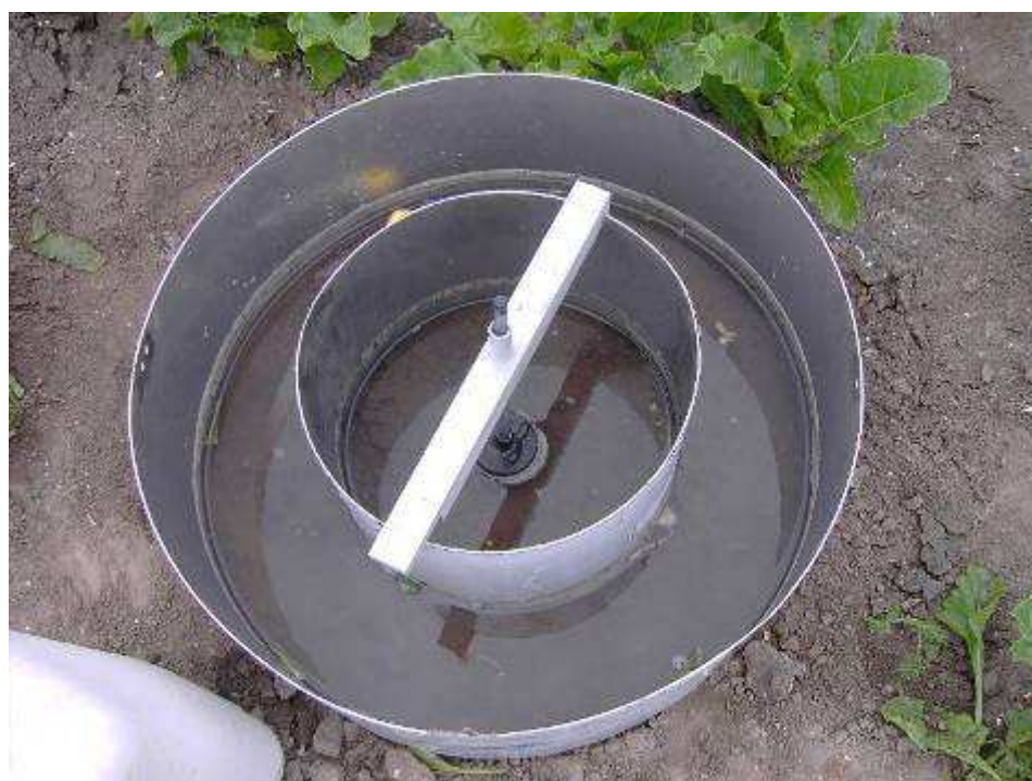
Foto 9. Infiltratiemeter tijdens meting in Lelystad
