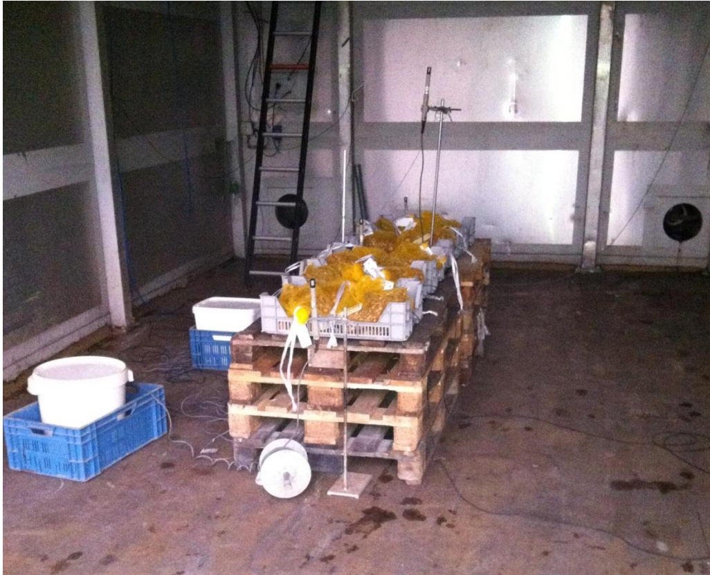
Foto 3: Proefopstelling stoombehandelingen met zakjes plantuitjes bij Ruvoma
