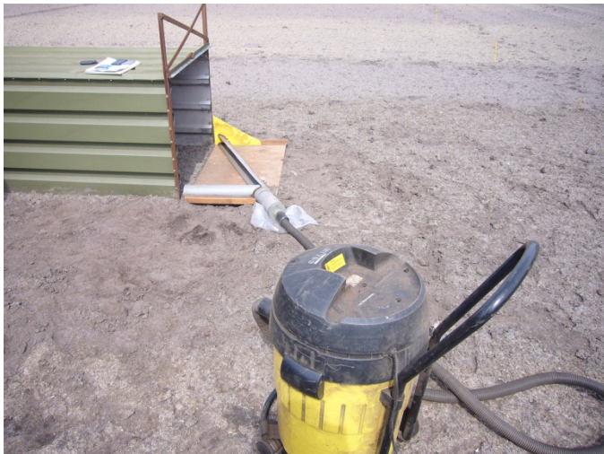
Foto 11. Op het eind van de tunnel wordt een deel van de luchtstroom opgevangen en afgezogen.
