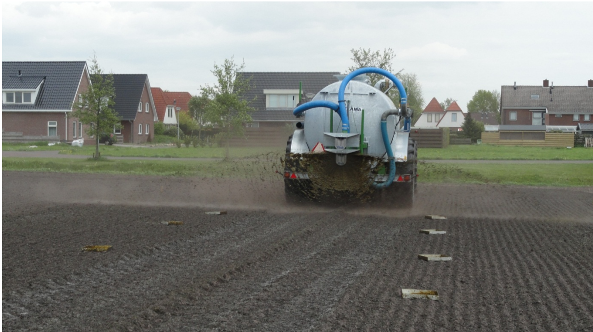
Foto 3. Breedte verspreiding van de mest door middel van de ketsplaat.
