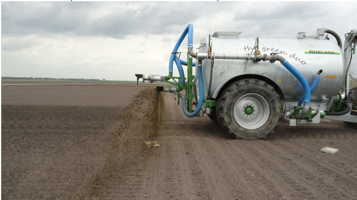
Foto 2. Bovengrondse toepassing van de rundveedrijfmest met een mesttank met ketsplaat.
