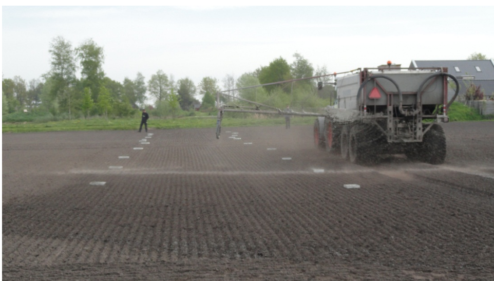
Foto 9. Toepassing van cellulose met een spuitboom met één spuitopening een één zijde.
