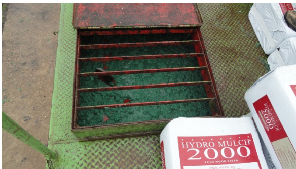
Foto 5. Bereiding van de houtmulchoplossing.
