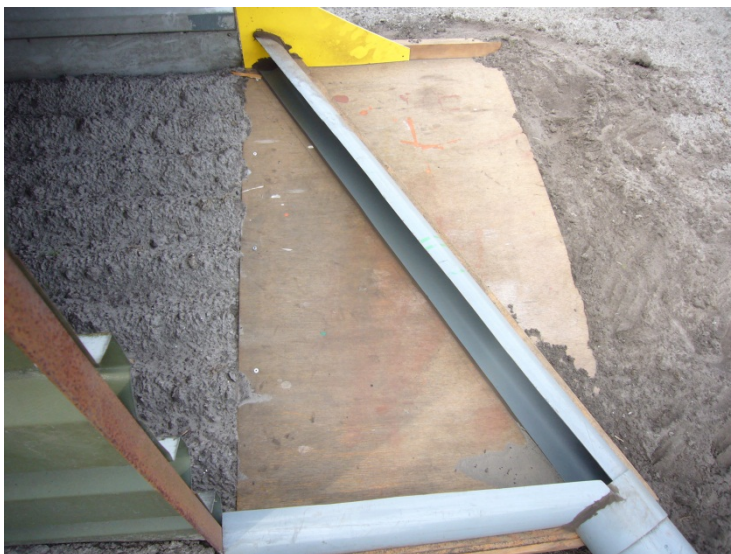
Foto 12. Detailopname van het eind van de tunnel waar een deel van de luchtstroom wordt opgevangen en afgezogen.
