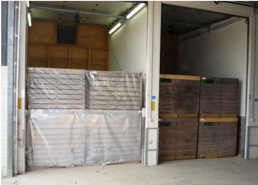
Figuur 6: In de cel links werd gezogen en in de cel rechts geblazen. Bij zuigen waren de voorzijde en bovenzijde zodanig dichtgemaakt dat de lucht alleen vanaf de beide buitenzijden kon toetreden. Boven in de cellen aan de ijzeren stangen hangen de Diabolo SL-vernevelaars.
