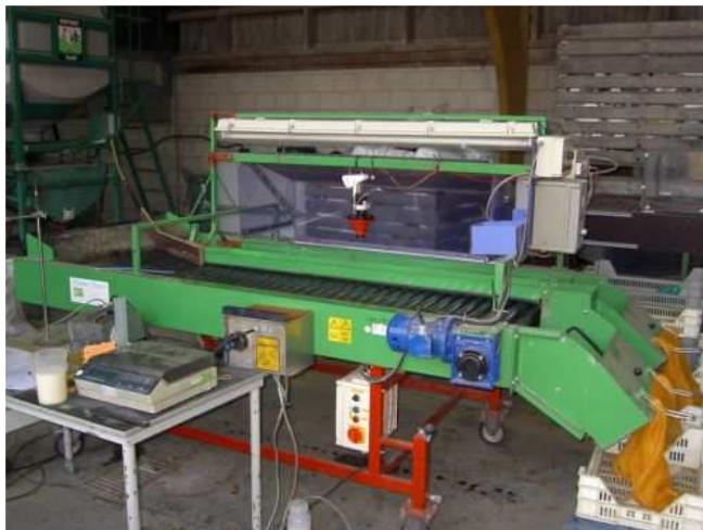
Foto 2. Rollenband zonder kap zodat de schijfvernevelaar zichtbaar is.
