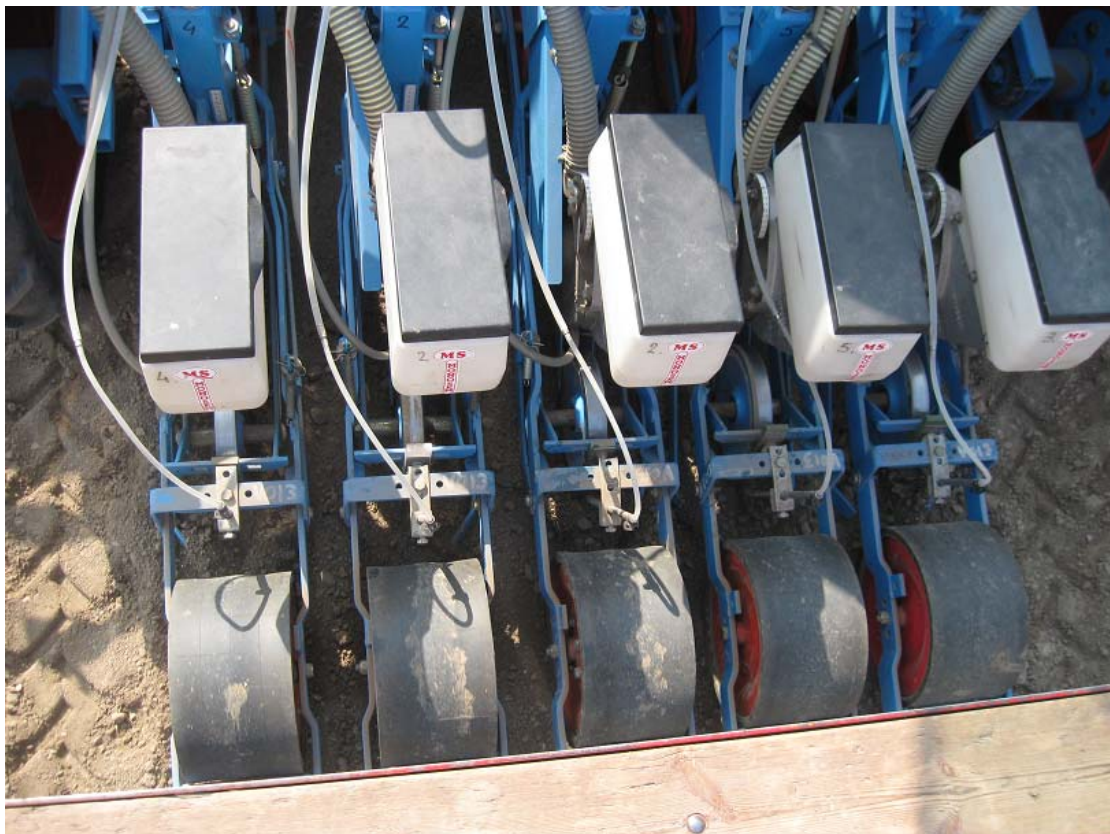
Figuur 3. De zaaimachine uitgerust met spuitdoppen waarmee de vloeibare meststoffen tijdens het zaaien zijn toegediend
