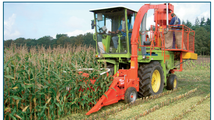
Oogst proeven met rijonafhankelijke proefveldhakselaar
