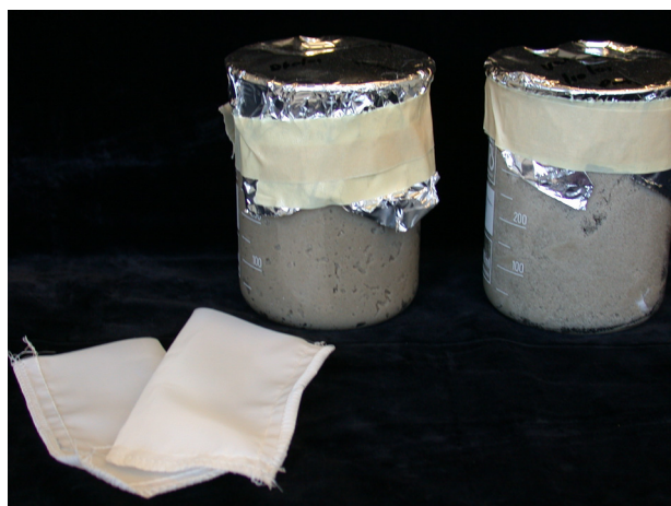
Figuur 10. Bekerglazen met zilverzand op veldcapaciteit (rechts) en zilverzand met vrij water (links). In beide objecten bevinden zich zakjes gemaakt van gaasstof met een 15 \mu\text{m} maas (zoals op de voorgrond) met daarin oösporen.
