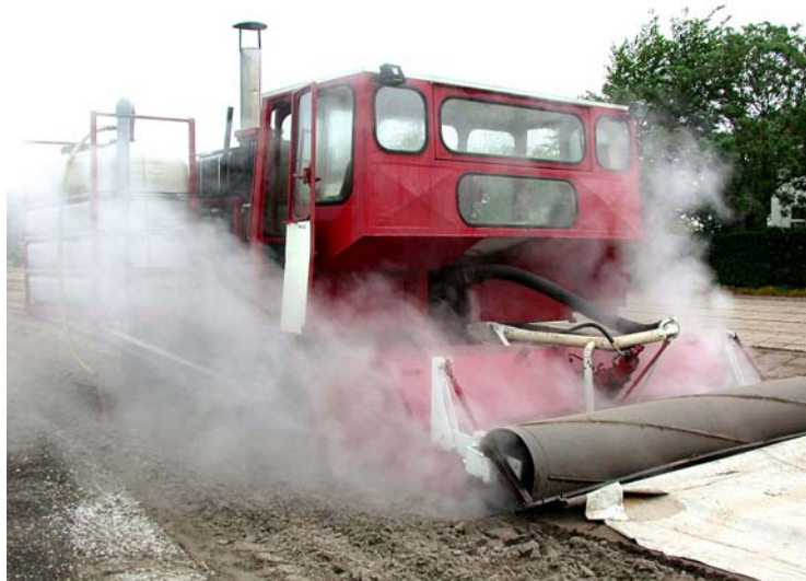
Mobiele stoominstallatie (injectie) op zandgrond.
