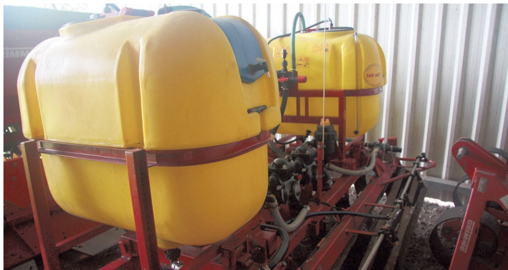
Twee tanks met meststof en een middel tegen ritnaalden doen hun werk tegelijk met poten en aanaarden.
