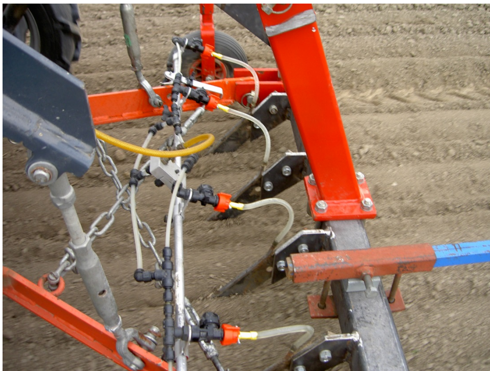
Figuur 3. Overzicht van het systeem waarmee vloeibare meststoffen naast de rij zijn geplaatst. De meststoffen zijn met deze machine op circa 8 cm diepte en op 8 cm naast de rij geplaatst.
