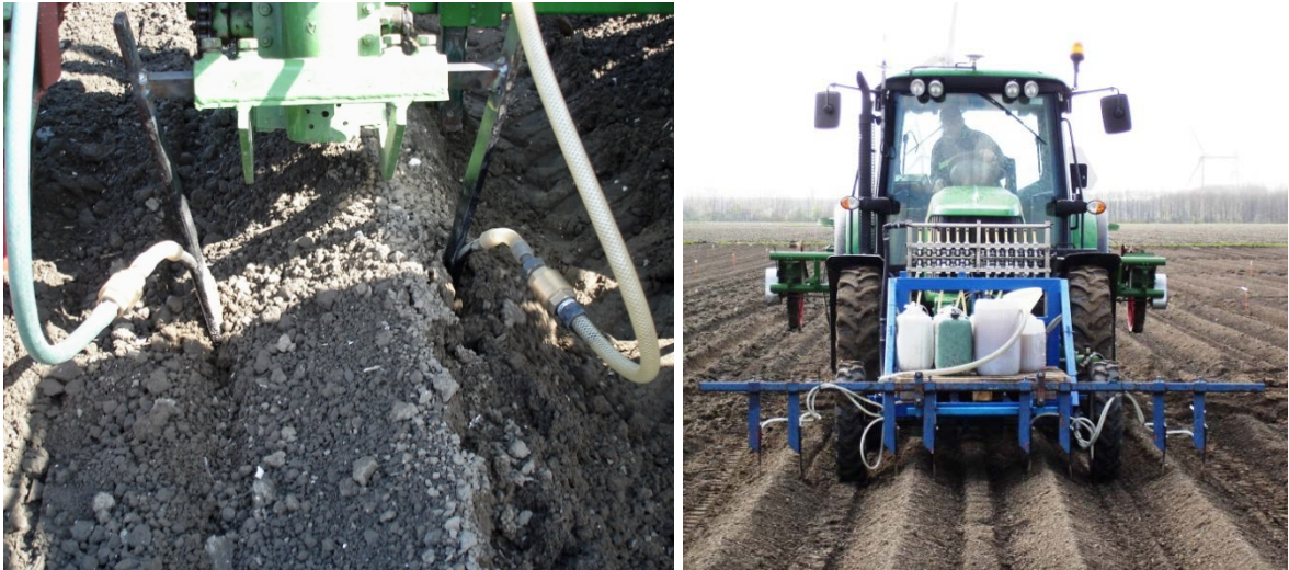
Figuur 3. Rijenbemesting met vloeibare N-meststoffen na poten
