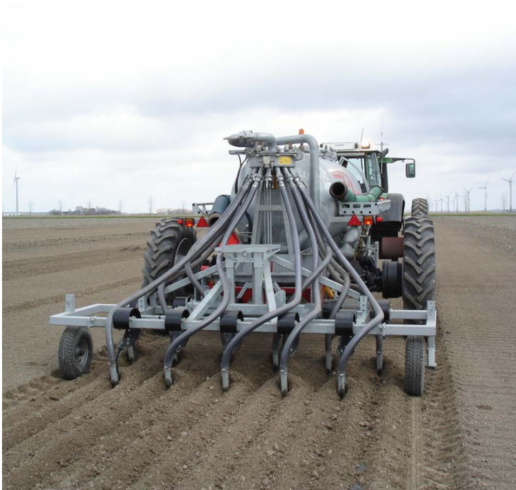
Figuur 3. Toediening van de varkensdrijfmest vóór poten met een bouwlandinjecteur in 2012
