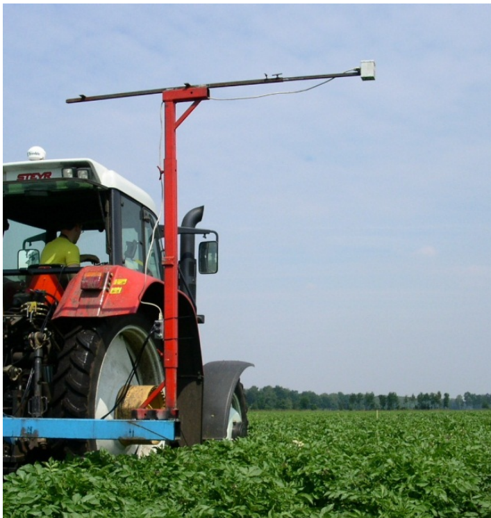
Figuur 16. Meting van de gewasreflectie in aardappel met de CropScan op een proefveld te Vredepeel
