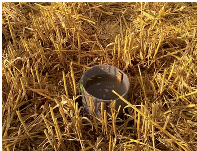
Foto 4.1 Meting verzadigde doorlatendheid
