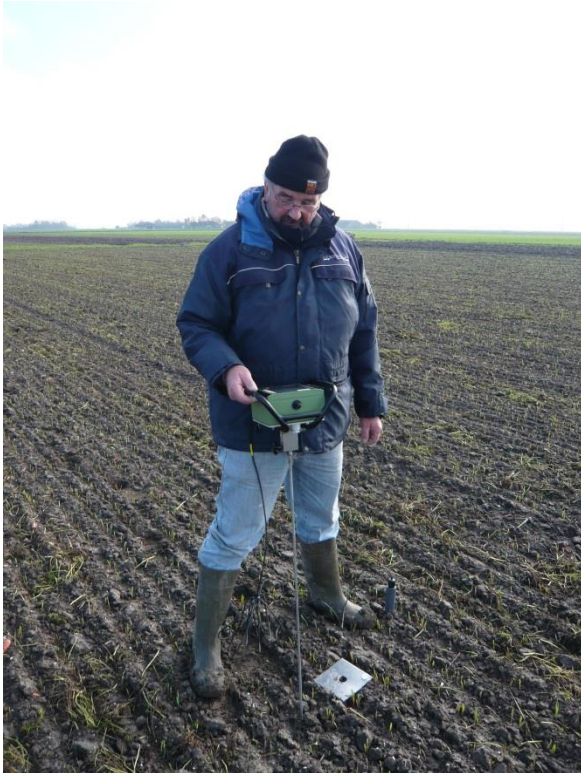
Figuur 2.2 Bodemweerstand meten met penetrologer
