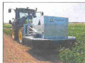
De Smart Ziekzoeker bestaat uit een meetbak met camera's.
