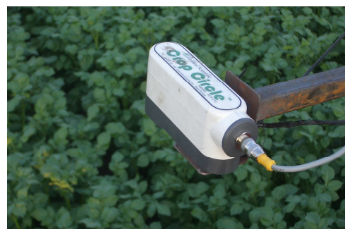
Figuur 13: de CropCircle sensor meet vlak boven het gewas
