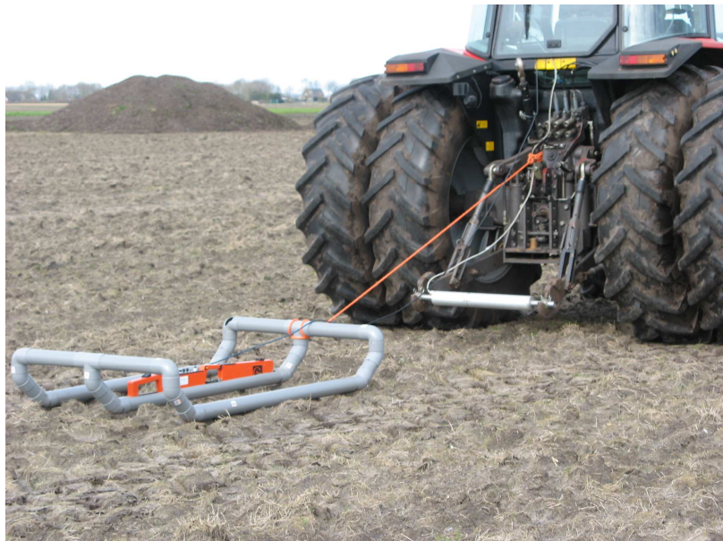
Figuur 3: meten met de EM38 (bron: The Soil Company)
