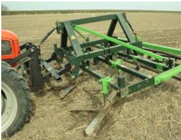
1c Volveldschoffel aangepast met schijven voor NKG toepassing
