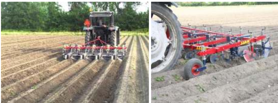
Figuur 7 “HAK” ruggschoffel/aanaarder met schijvenschoffels
