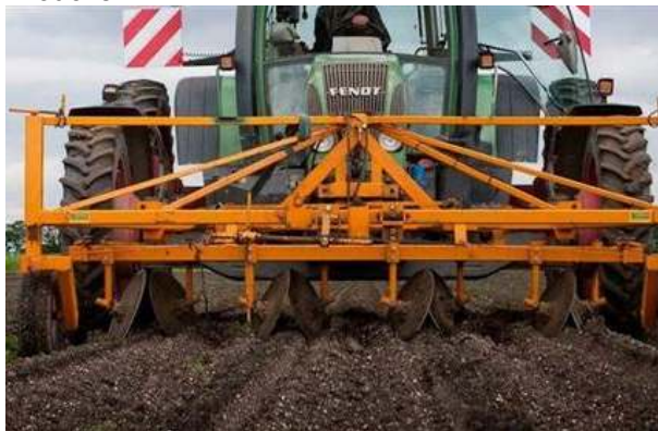
1c Schijvenschoffel (hydraulisch verstelbaar) Voor zowel ruggen als vlakvelden
