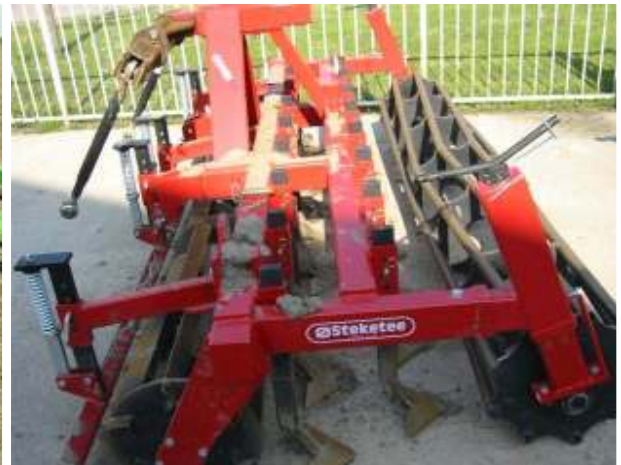
1d Volvelds ganzevoetschoffels in zaaibedbereider
