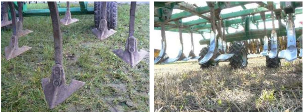
Figuur 9. Brede vleugelscharen zijn effectiever in het afsnijden van gewasresten en onkruiden. De overlap van de beitels is bij veel merken echter te weinig om alles volledig af te snijden (links).
