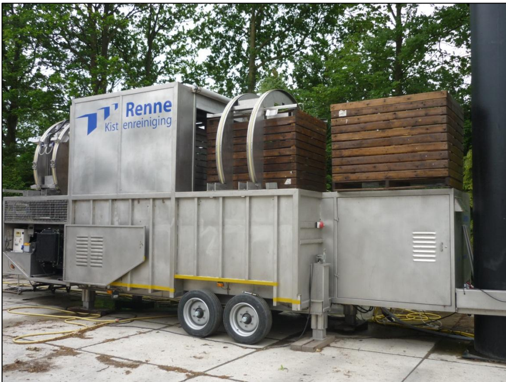
Foto 6 Uitvoer kist na openen rolgordijn en terugkantelen kist
