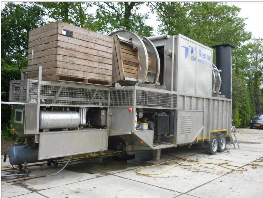
Foto 4 Ondersteboven kantelen van kist voor reiniging
