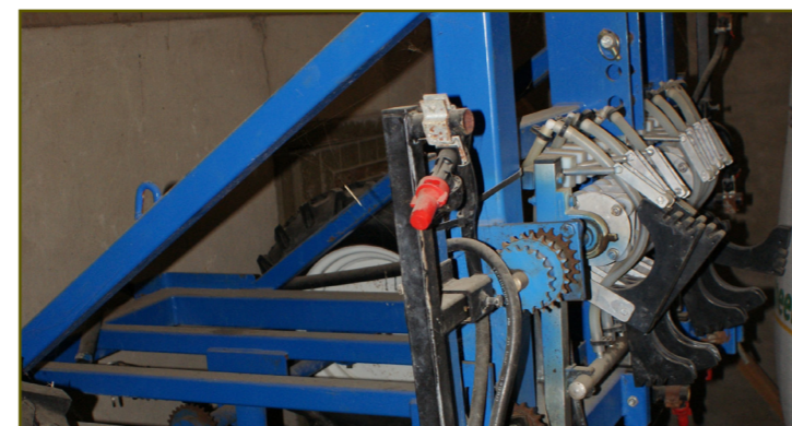
Met de slangenpompmachine kan René Zijlmans de vloeibare meststoffen precies doseren.
