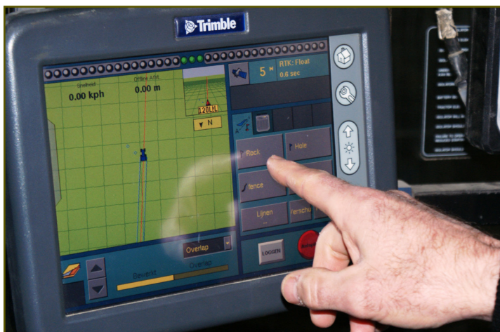
Dankzij GPS weet René Zijlmans bij het aardappelen frezen op de rij af waar hij de dosering van de vloeibare meststoffen moet aanpassen.
