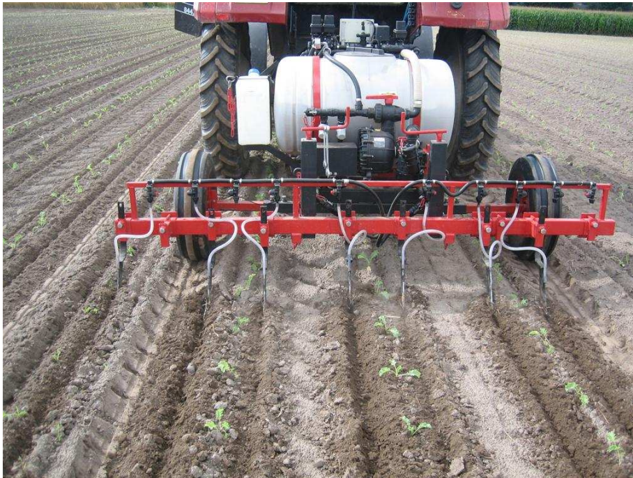
Figuur 2.1 Foto rijenbemester vloeibare meststoffen Rusthoeve 2009
