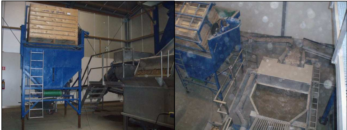
Foto's 1 en 2 Aardappelen worden vanuit kuubskisten gestort in stortbak en getransporteerd naar spoelbak om grond te verwijderen.
