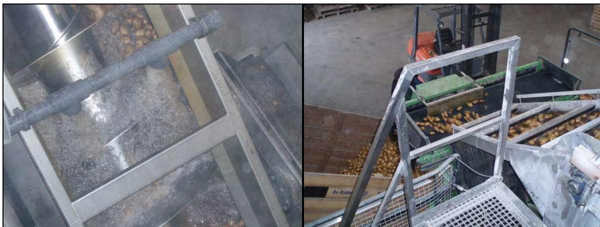
Foto's 3 en 4 Op een schoepenrad worden aardappels gereinigd onder hoge druk met ozon behandeld water en verder getransporteerd naar de ontsmettingsunit en vervolgens via transportband naar schone opvangkisten.
