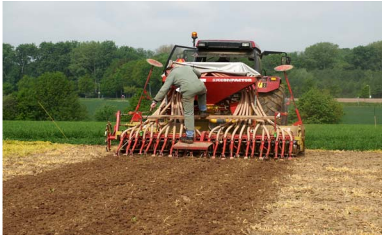
Foto 1. Zaaïen van de soja met een pneumatische zaaimachine.
