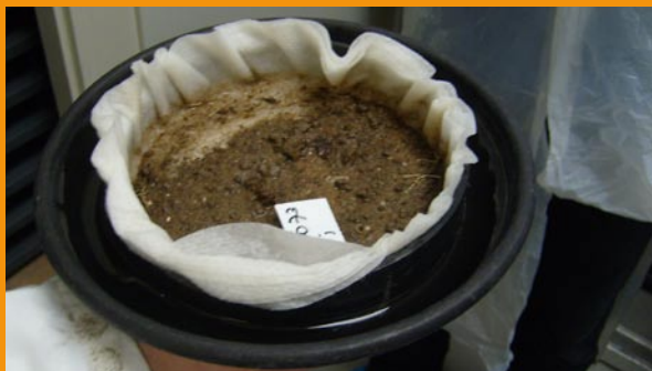
Incubatieopstelling om aaltjes uit plantenresten te laten komen
